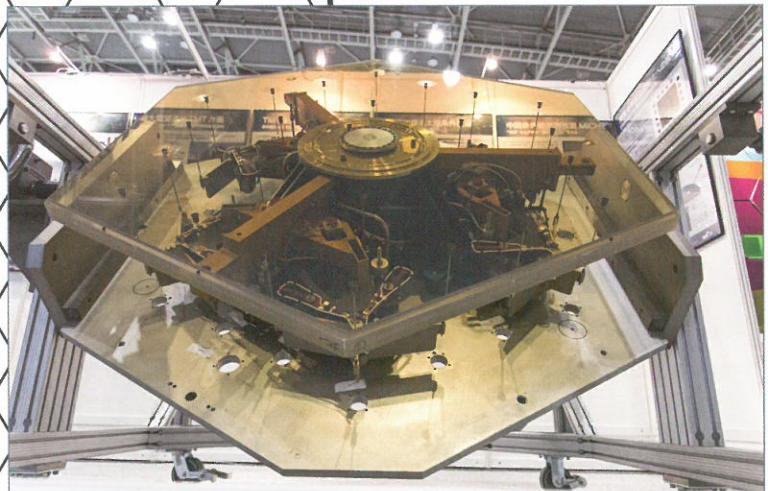
昨年度日本で試作された主鏡分割鏡。実際に表面加工が行われたもので、測定のために鏡の支持機構（これは米国で製作された試作品）に搭載されています。この表面に金属膜のコートが施され、反射率の高い鏡となります（14ページも参照）／撮影：長山省吾。
