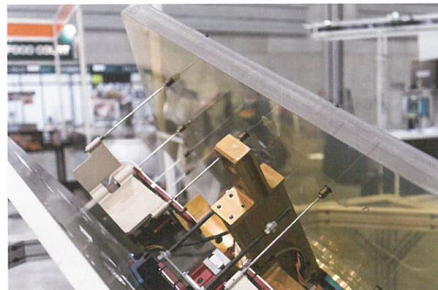
セグメントミラーの保持機構：複数枚並べた鏡面の位置をナノメートルオーダーで制御を行い、492枚が理想的な回転双曲面になるようにする。
